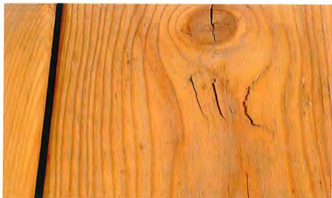
Schilfer/Ablösung der Jahrringe bei Nadelhölzern; darüber trocknungsbedingter Riss im gesunden Ast Foto: © J. PlöbI
