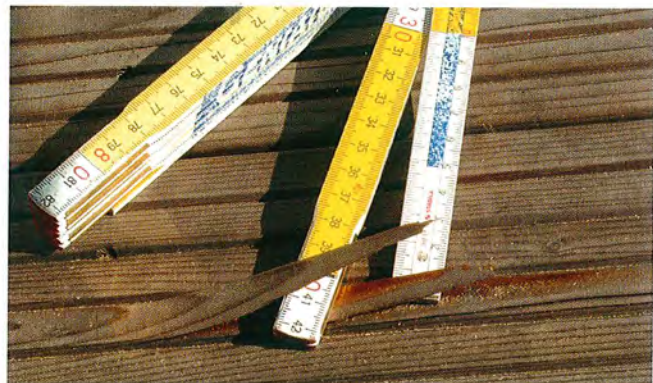
Ringschäle bei Nadelhölzern Foto: © J. PlöbI
